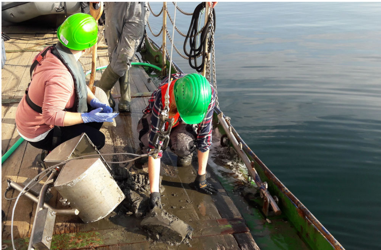
Abbildung 5.3: Zwei Forscherinnen des GEOMAR sichern eine Sedimentprobe, die zuvor mit einem Kastengreifer (unten links im Bild) vom Grund der Lübecker Bucht an Bord der POSEIDON gehievt wurde (Foto: Uwe Wichert, MELUND SH, 2018).
