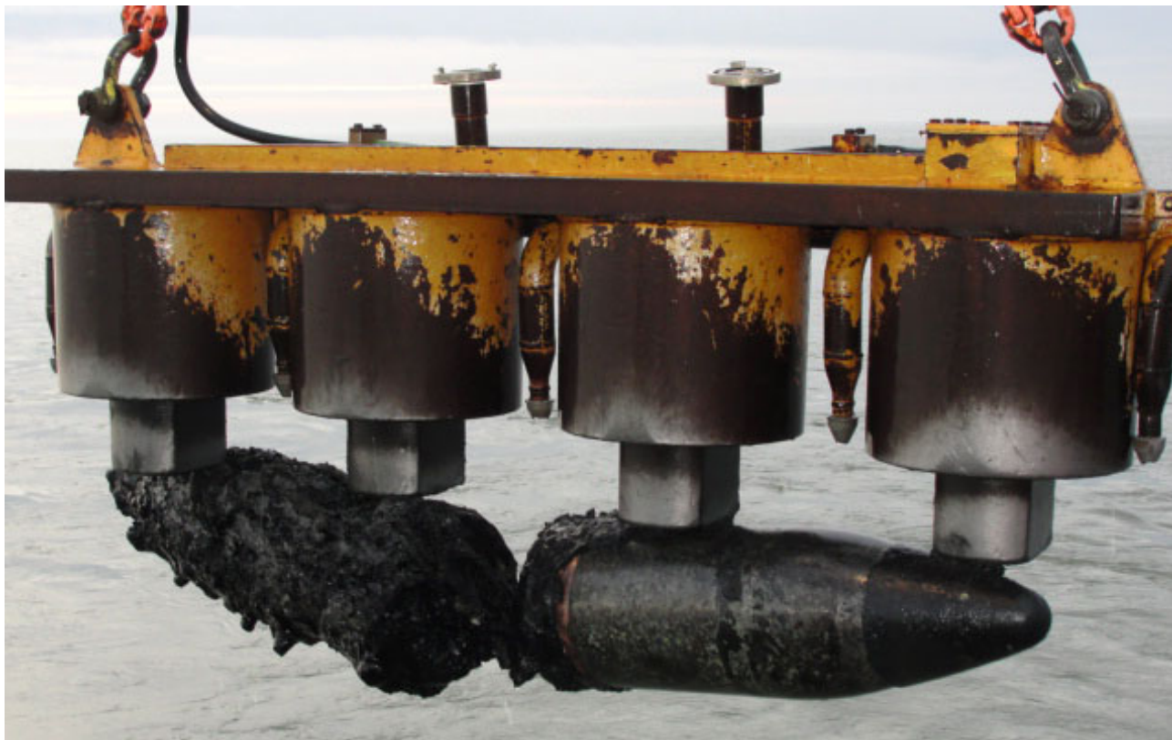
Abbildung 1.2: Unterwasser-Elektromagnete zum Bergen der Fundmunition. Bei Unterwasserbergungen im Bereich der niedersächsischen Nordsee werden durch die Bergungsunternehmen modernste Techniken wie diese eingesetzt, um die Bergungen der aufgefundenen Kampfmittel mit einem hohen Sicherheitsstandard für das eingesetzte Personal durchführen zu können (Foto: Heinrich-Hirdes EOD Services GmbH, 2018).
