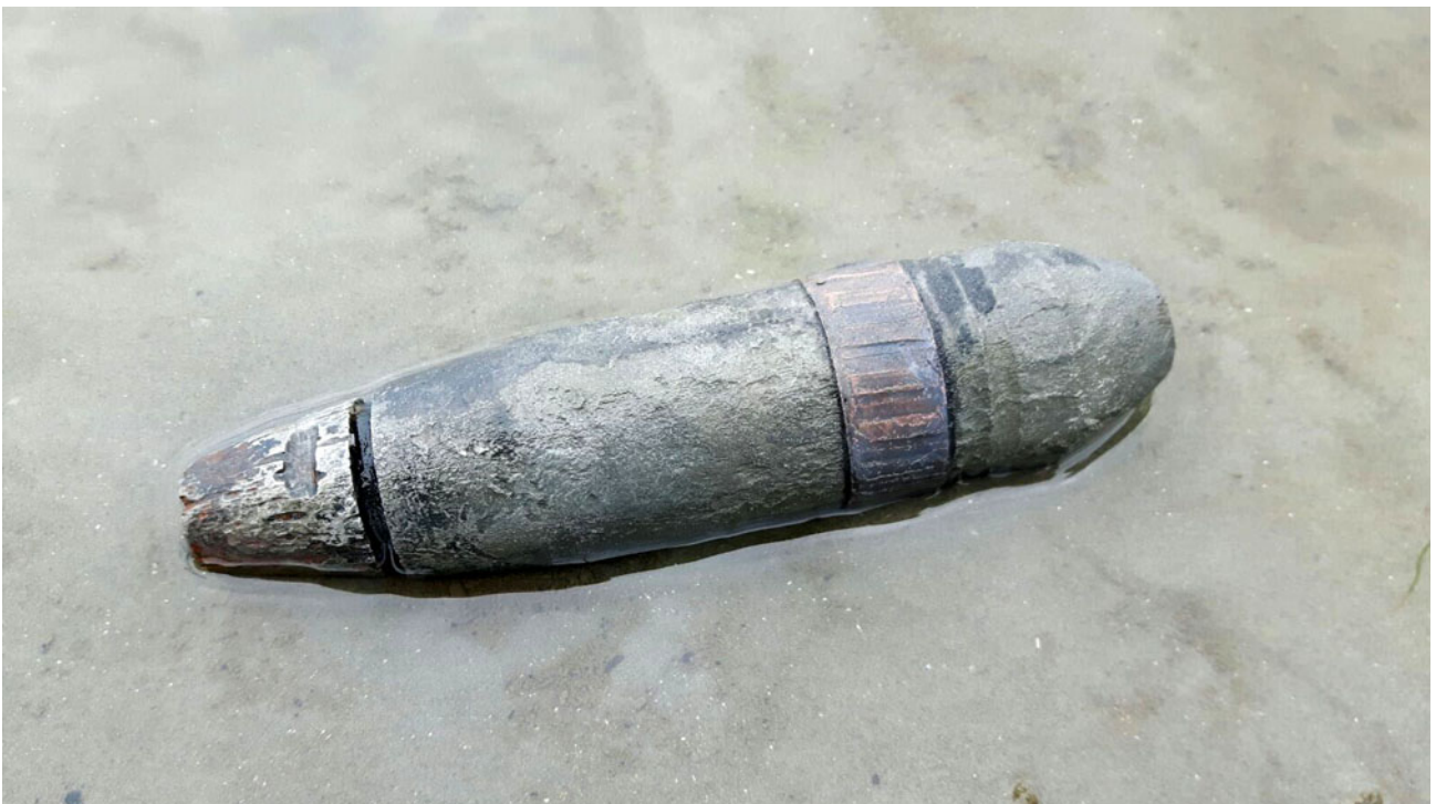
Abbildung 1.4: Granate im Watt – Deutlich erkennbar sind die Abdrücke der Züge und Felder des Kanonenrohrs im Buntmetallring am hinteren Ende der 4,0 cm Granate: Spuren, die beim Verschießen entstanden sind und somit auf einen Blindgänger hinweisen (Foto: Peter Bodes, Kampfmittelräumdienst Hamburg, 2017).
