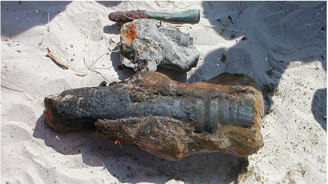
Abbildung 1.3: Granate am Strand – Mit starken Verkrustungen behaftete Sprenggranate des Kalibers 8,8 cm: Durch Korrosion ist der Zünder nur noch teilweise vorhanden. Im Hintergrund ist eine 2 cm Panzersprenggranate zu sehen (Foto: Kampfmittelbeseitigungsdienst Niedersachsen, 2017).
