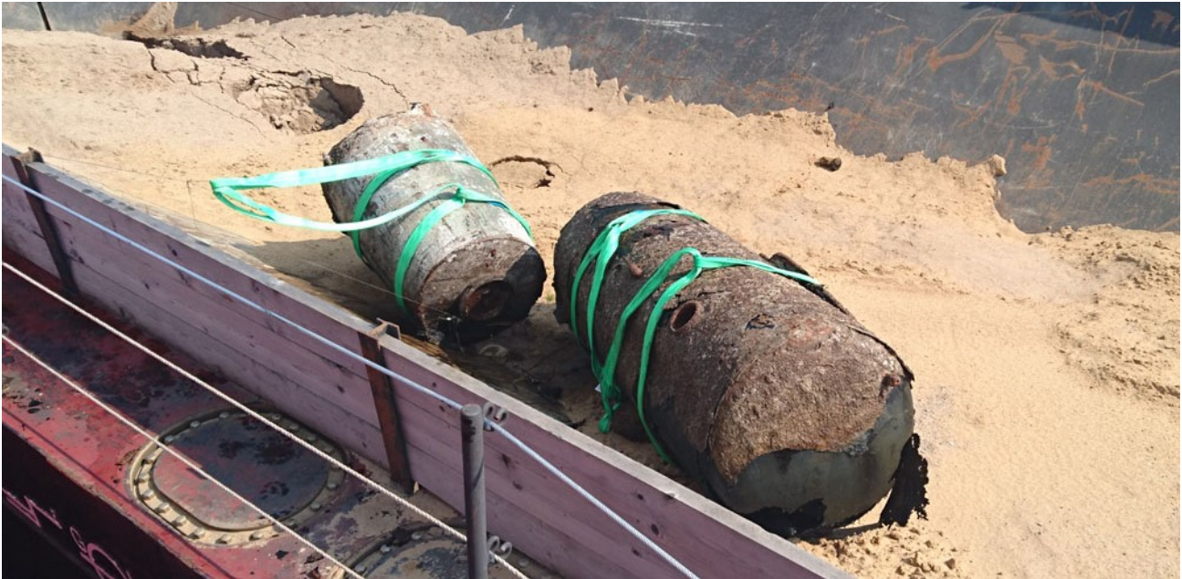
Abbildung 1.5: Aus der Ostsee vor Schleswig-Holstein geborgene Kampfmittel an Bord einer Schute: Im Hintergrund ein Sprengkopf (ca. 140 kg), im Vordergrund ein Druckkessel (Foto: Kampfmittelräumdienst Schleswig-Holstein, 2016).
