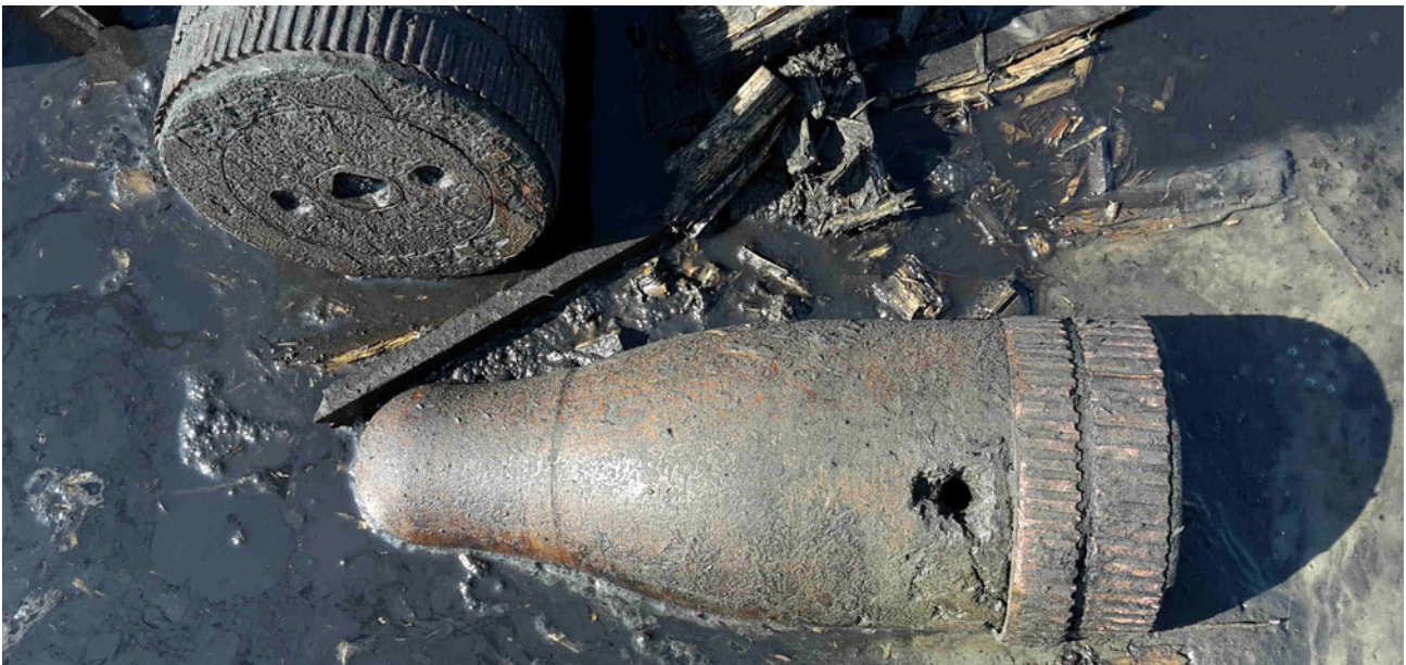
Abbildung 1.4: Granate im Watt: Deutlich erkennbar sind die Abdrücke der Züge und Felder des Kanonenrohrs in dem Buntmetallring am Granatenboden – Spuren, die beim Verschießen der Granaten entstehen und ein wichtiger Hinweis auf einen Blindgänger sind (Foto: Hans Mohr, Kampfmittelbeseitigungsdienst Niedersachsen, 2016).
