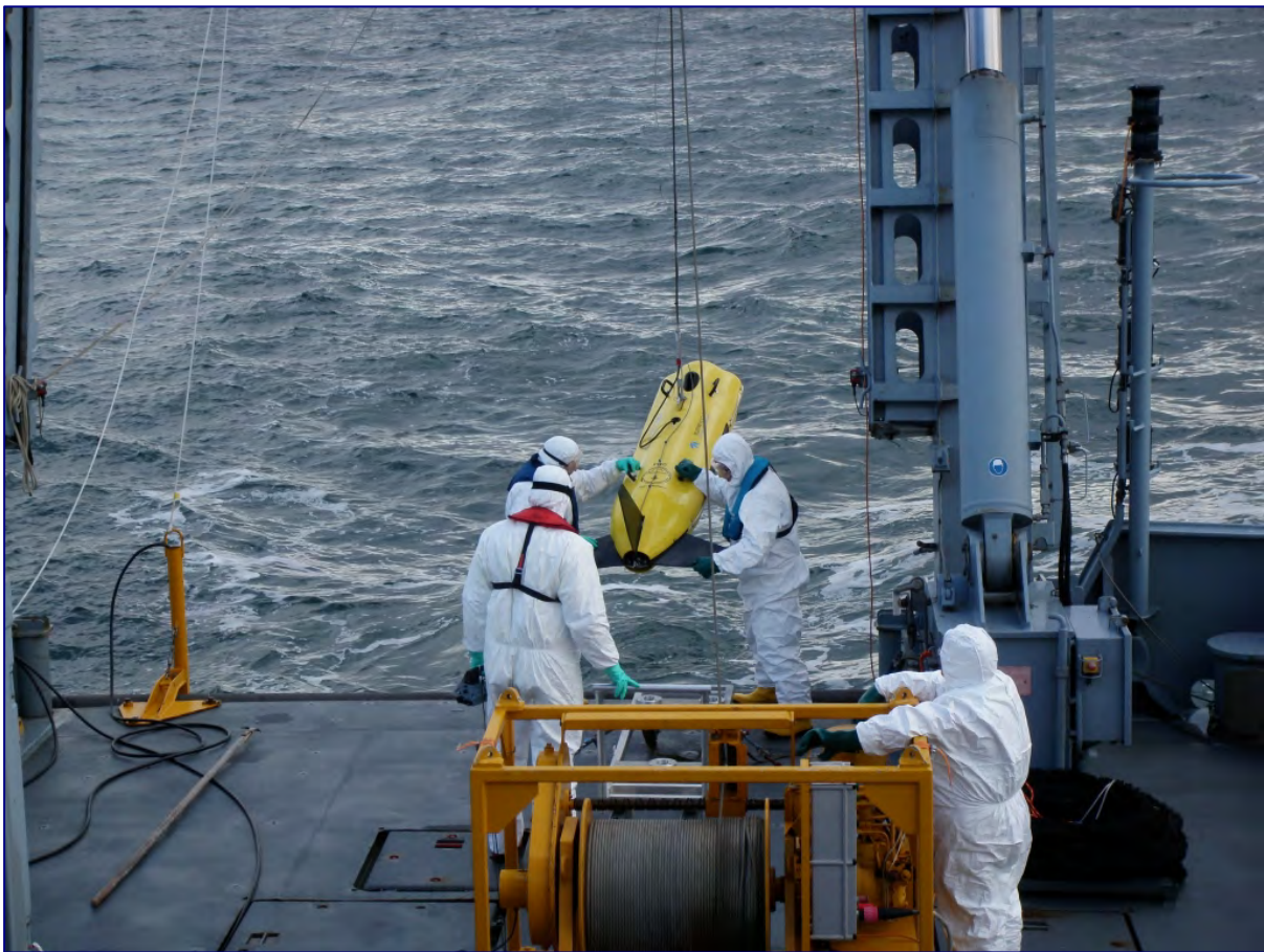
Abbildung 11: Aus dem Archiv: Einsatz eines Sidescan-Sonars im Jahr 2009 vor Helgoland
