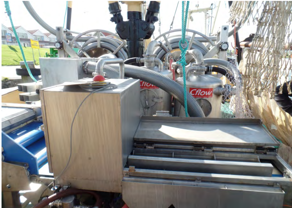
Abbildung 152: De Boer RVS Garnelensortierung. Im Hintergrund die Schlauchtrommeln, davor die Vakuumtanks, links der Wassertank für den Fang, ganz links die Zuführung des Fanges zur Fotoeinrichtung, die sich in dem großen Kasten befindet, rechts vorn im Vordergrund die Anlage mit den vier Förderbändern und der Druckluftanlage.
