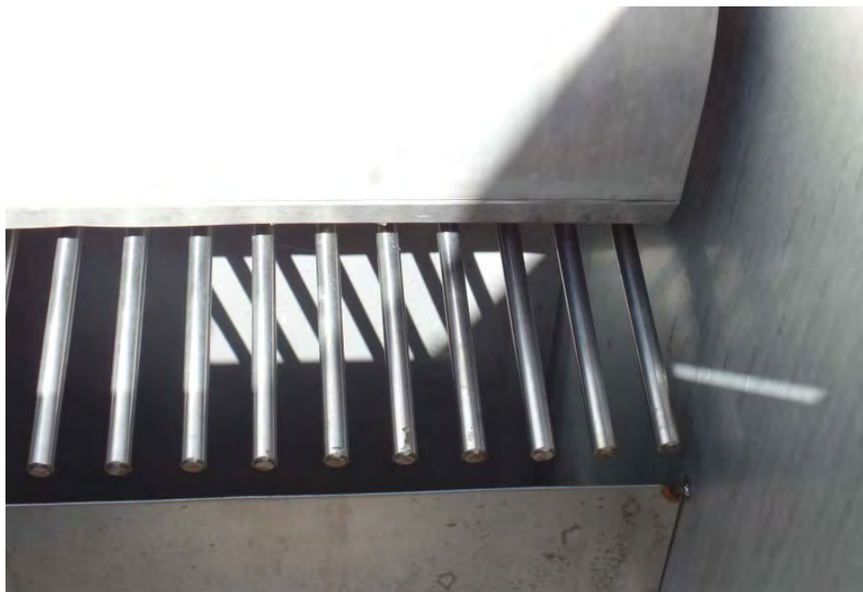
Abbildung 151: De Boer RVS Garnelensortierung. Vorsortierung vor den Förderbändern: großer Beifang wird durch die groben Edelstahlstäbe weggeleitet. Garnelen und kleiner Beifang fallen nach unten auf die Förderbänder
