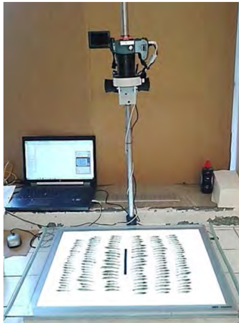
Abbildung 6: Aufbau der Messstation im Labor des Thünen-Instituts für Seefischerei in Hamburg Altona.
