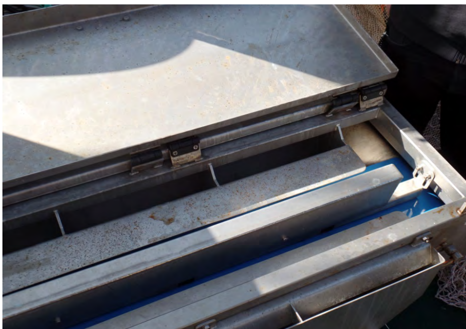
Abbildung 153: De Boer RVS Garnelensortierung. Blick in den Bereich der Förderbänder (die Luftdüsen sind im dunklen Bereich nicht erkennbar), die den Beifang nach rechts und links weg transportieren
