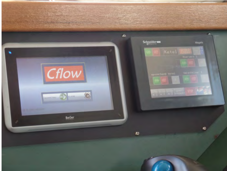
Abbildung 154: De Boer RVS Garnelensortierung. Die Displays im Ruderhaus, auf denen der Zustand der Vakuumanlage, der Bildanalyse und der Anteil an Garnelen verschiedener Größen abgelesen werden kann.
