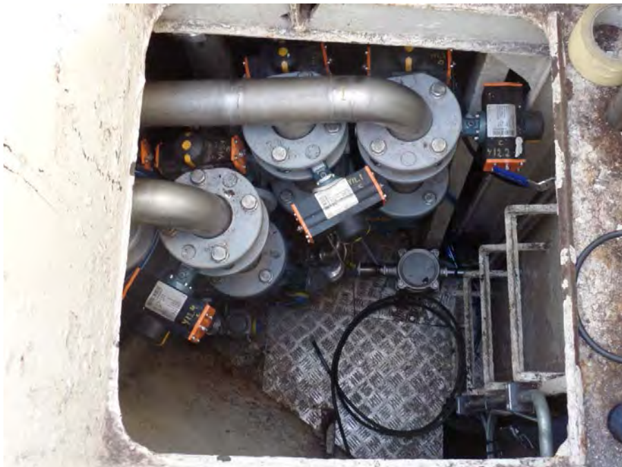
Abbildung 149: De Boer RVS Garnelensortierung. Im Bug des Schiffes ist auf engstem Raum die Pumpenanlage untergebracht
