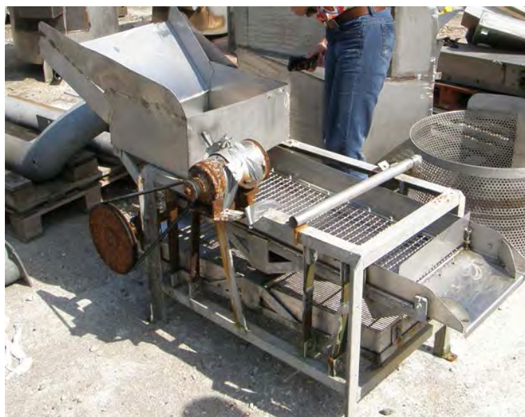
Abbildung 140: Beispiel einer kleinen Sortiermaschine nach dem Rüttelprinzip, hergestellt von der früheren Firma Kölln in Marne
