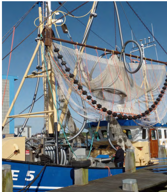
Abbildung 146: De Boer RVS Garnelensortierung. Der Saugschlauch im Fanggeschirr ist deutlich zu erkennen.
