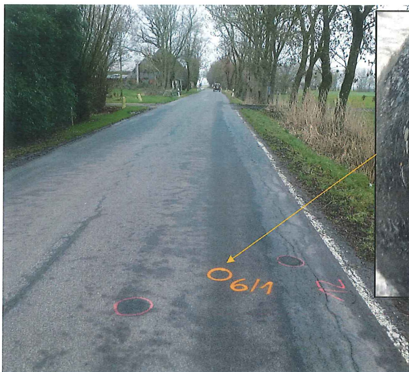
Oberfläche des Klinker-/Ziegelpflasters (20 cm unter OK Asphalt)
