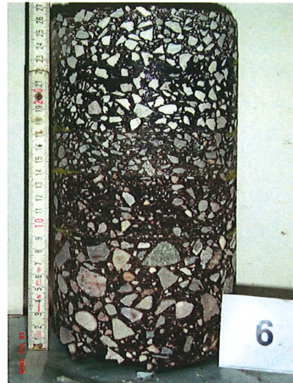
Bild Nr. 12: Mantelfläche Bohrkern Nr. 6
