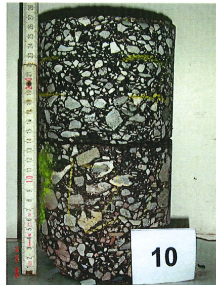
Bild Nr. 20: Mantelfläche Bohrkern Nr. 10
