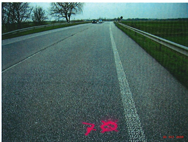
Bild Nr. 13: Entnahmestelle Bohrkern Nr. 7
