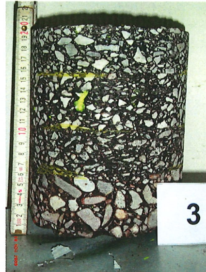
Bild Nr. 6: Mantelfläche Bohrkern Nr. 3
