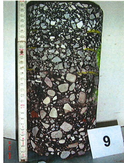
Bild Nr. 18: Mantelfläche Bohrkern Nr. 9
