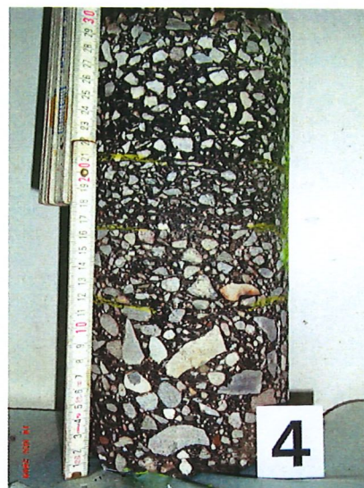
Bild Nr. 8: Mantelfläche Bohrkern Nr. 4
