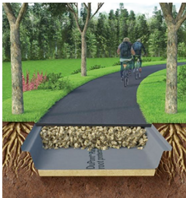
Abb. 26: Wannenförmiger Einbau von Wurzelsperren.
