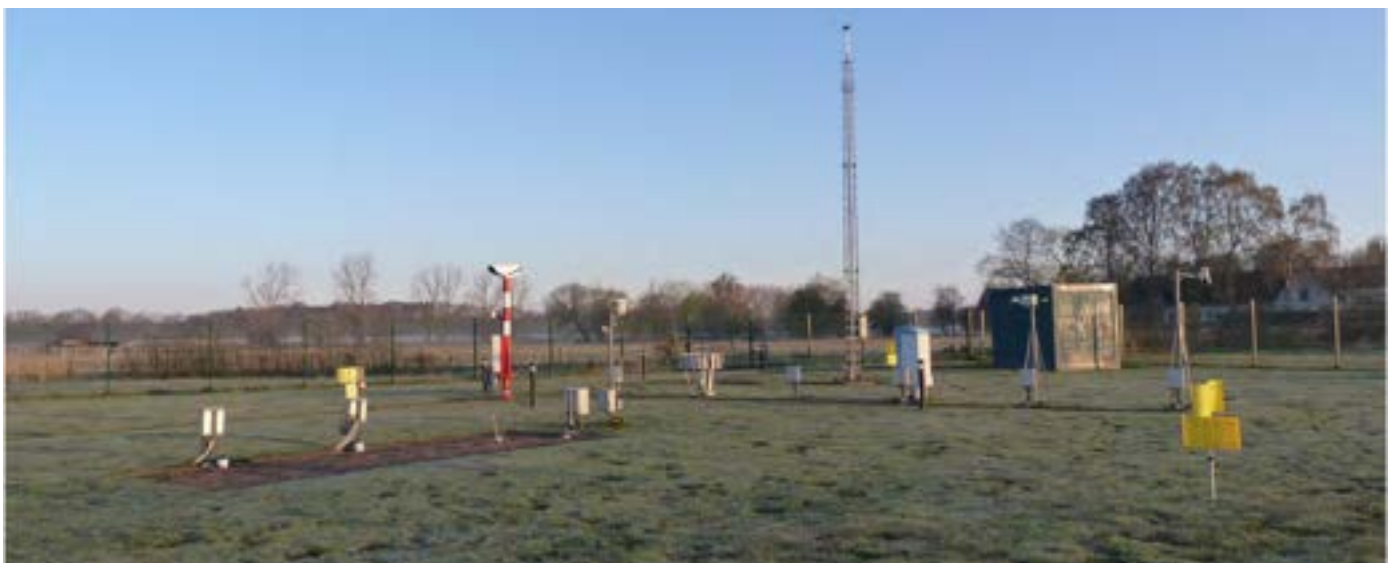
▲ Messfeld der Wetterstation Quickborn. Hier werden unter anderem Luft- und bodennahe Temperaturen sowie Niederschlag, Wind und der Bedeckungsgrad des Himmels gemessen.
