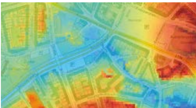
▲ Ausschnitt einer Relieffklassifikationskarte nach dem topographischen Klassifikationsindex für das Flachland am Beispiel Kiel. Blaue Farben kennzeichnen Senken, an die bei Starkregen erhöhte Anforderungen an die Entwässerung gestellt werden (Quelle: LLUR).
