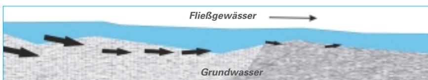
Abb. 2. Vertikale Durchgängigkeit: schematischer Querschnitt durch ein Fließgewässer mit den Bachsedimenten. Die Pfeile symbolisieren den Austausch zwischen Oberflächenwasser und Grundwasser in den Bachsedimenten.
