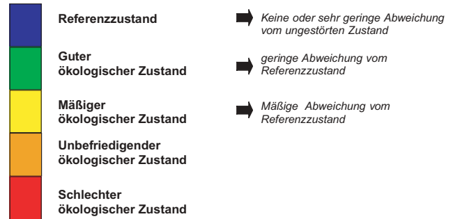
Abb. 1 (unten). Prinzip der Klassifizierung des ökologischen Zustandes von Gewässern gemäß WRRL auf der Basis des Vergleichs zwischen aktuellem Zustand und Referenzzustand (verändert nach CIS-Papier Refcond).
