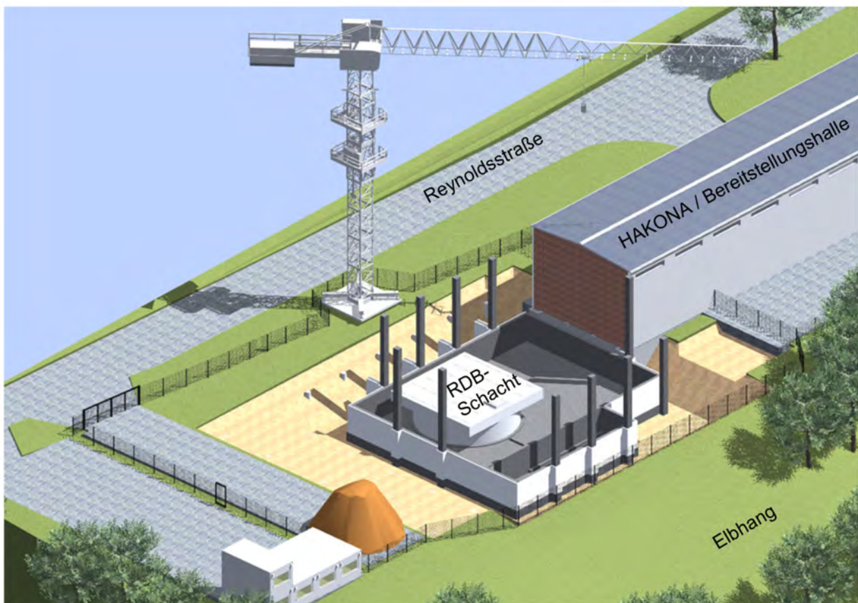
Abbildung 2: Rohbau des tief liegenden Hallenteils mit Schacht
