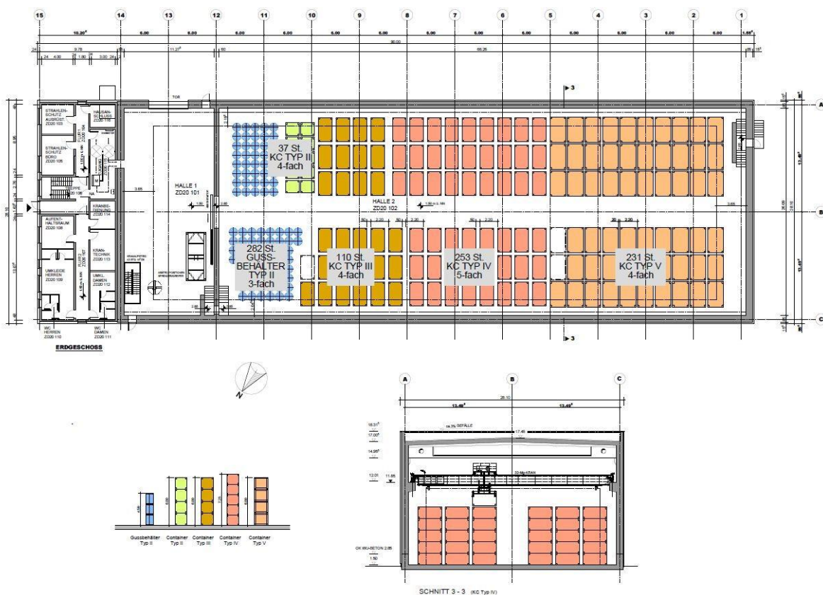
Abbildung 11: Grundrisse und Schnitte der geplanten TBH-KBR Beispielbelegung)
