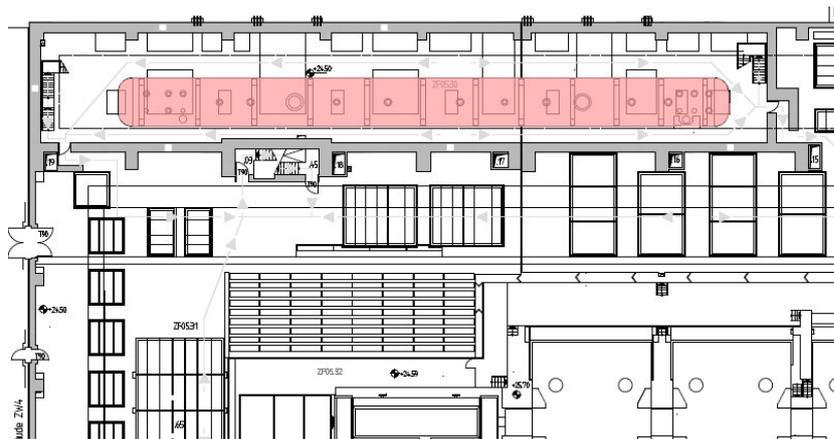
Abbildung 3-8: Lage des Speisewasserbehälters in Raum F05.30 auf Ebene + 24,50 m
