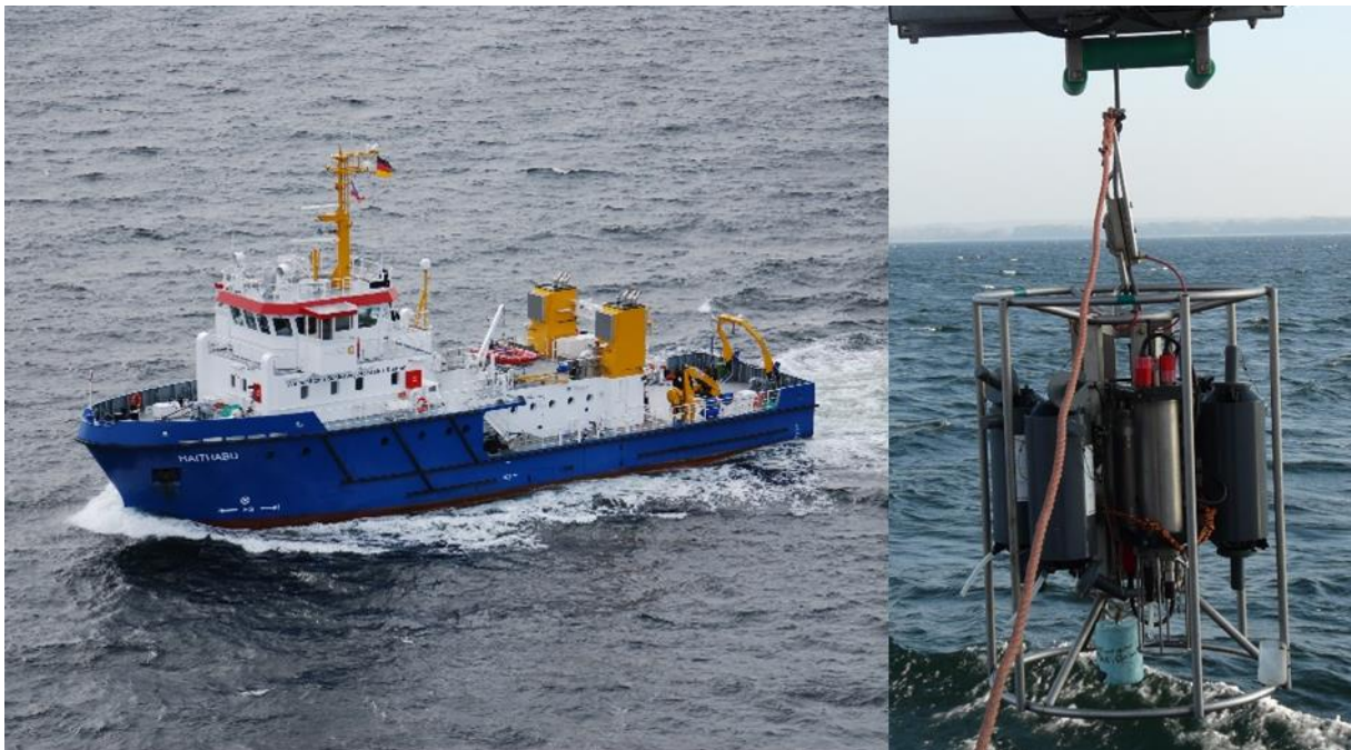
Abbildung 1: links: MS „Haithabu“ beim Monitoring-Einsatz in der Ostsee (Foto: C. Steffens), rechts: Rosette mit Wasserschöpfern und Multiparametersonde (Foto: LLUR)
