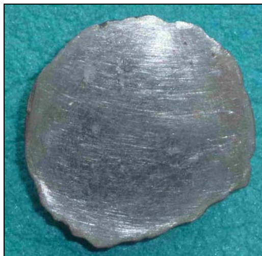
Abb. 36: Anpolierte Schnittfläche, Legierung einer Panzergranate.
