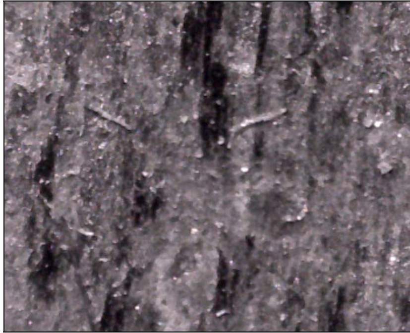
Abb. 37: Schnittfläche mit schwarzen Korrosionsdefekten nach Seewasserkontakt; V X 40.
