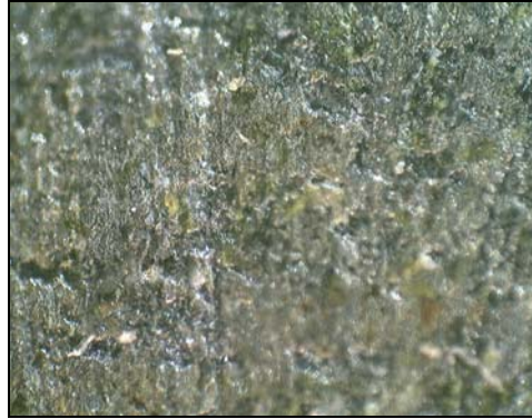
Abb. 44: SchW39a; Anschliff mit gelben Hexyleinsprenglingen V X 20.
