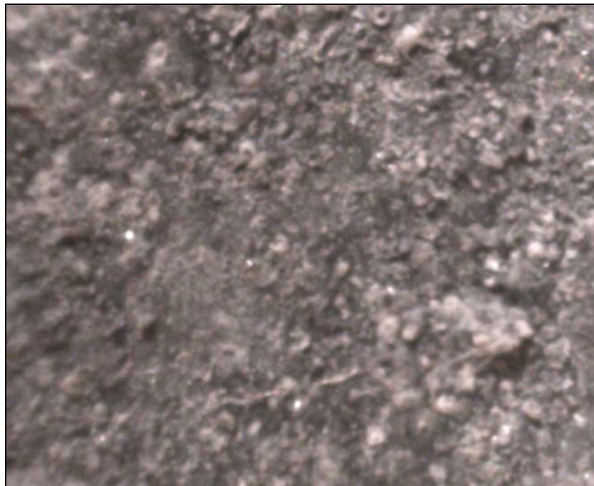
Abb. 38: Schnittfläche mit Oberflächenabtragung nach Seewasserkontakt mit STV; V X 40.
