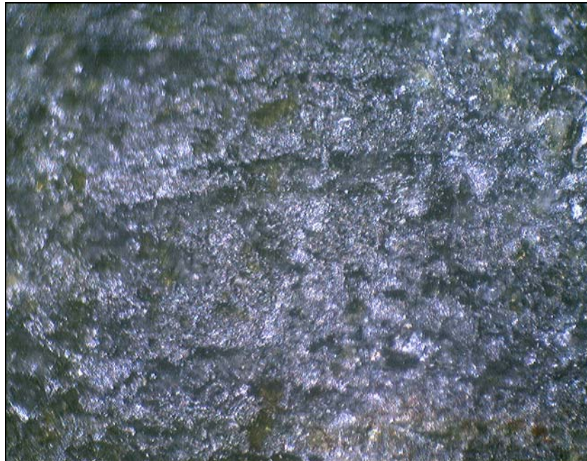
Abb. 27: Oberfläche Schw39a, frischer Schnitt V:X20. Metallische Aluminiumaggregate und mit gelblichen Einsprenglingen aus Hexyl.
