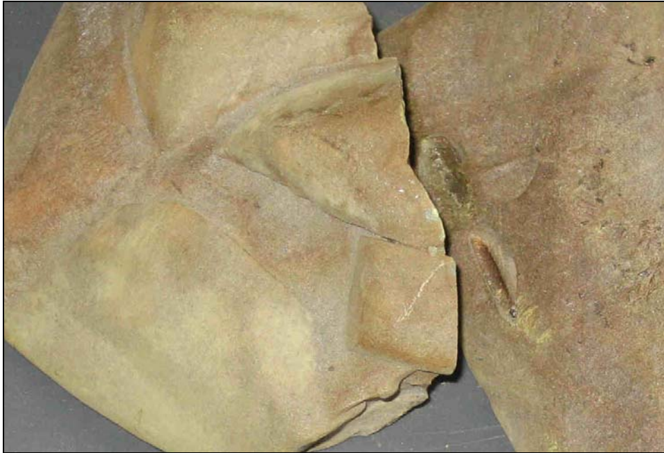
Abb. 45: Marinesprengstoff mit deutlichen Spuren von Strömungserosion mit meist glatten Kanten; Auffällig ist die Abwesenheit dunkler Krustenbildung, was auf näherungsweise gleichmäßige Erosion unter Wasser schließen lässt.*
