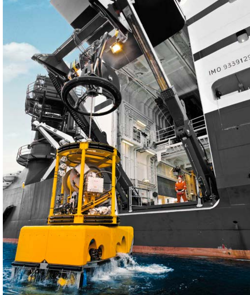
Launch and Recovery System (LARS) eines kabelgeführten Unterwasserfahrzeugs (ROV)
