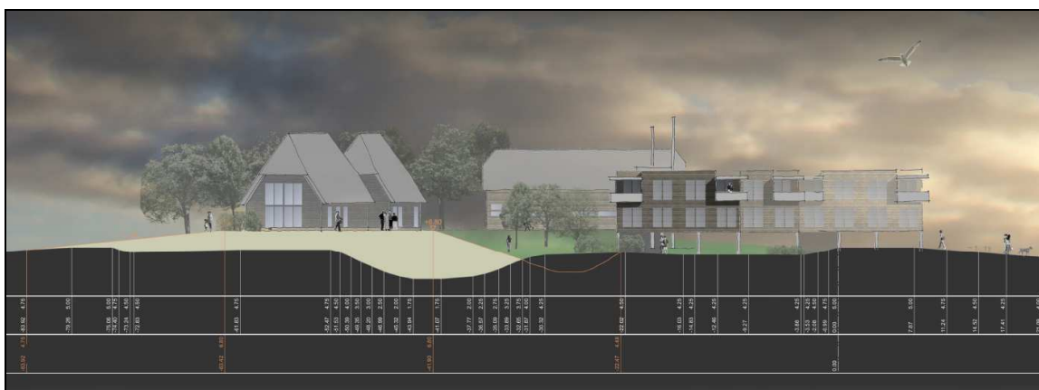
Abb. 16: Innere Warfterhöhung mit einer Kombination aus traditionellen Hausformen und teilaufgeständerten modernen Neubauten.
