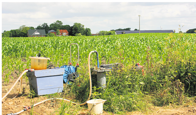
Grundwassermessstellen im Mais liefern Aufschlüsse hinsichtlich der Nährstoffausträge. Fotos: Dr. Frank Steinmann
