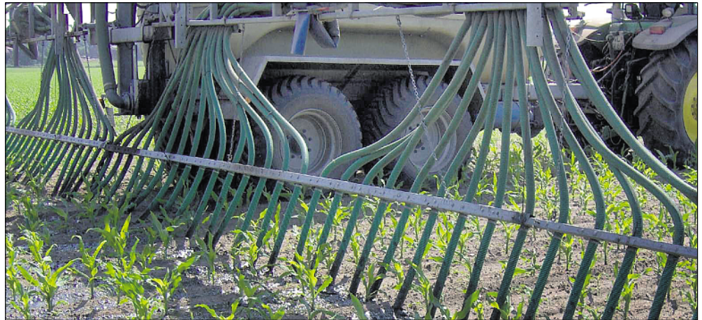
Mithilfe der Schleppschlauchtechnik und der Auswahl des Ausbringungszeitraumes sind deutliche Vorteile hinsichtlich der Stickstoffausnutzung von Wirtschaftsdüngern zu erzielen. Foto: Geries Ingenieure
