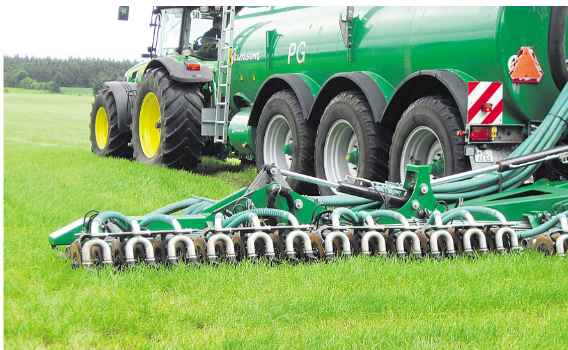
Gülldirektausbringung durch Injektion über Schlitztechnik in Grünland.
