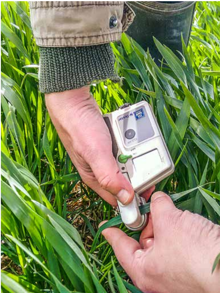
Bild 2: Mit dem Yara-N-Tester lässt sich der Düngebedarf im Vegetationsverlauf ermitteln. Fotos (3): Julia Brede
