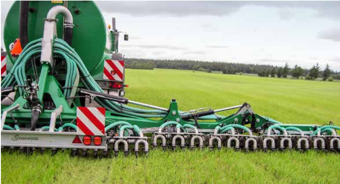
Einsatz von Schlitztechnik auf Grünland nach dem ersten Schnitt birgt ein hohes Einsparpotenzial an Mineraldünger auf Grünland. Foto: Dr. Udo Müller-Thomsen
