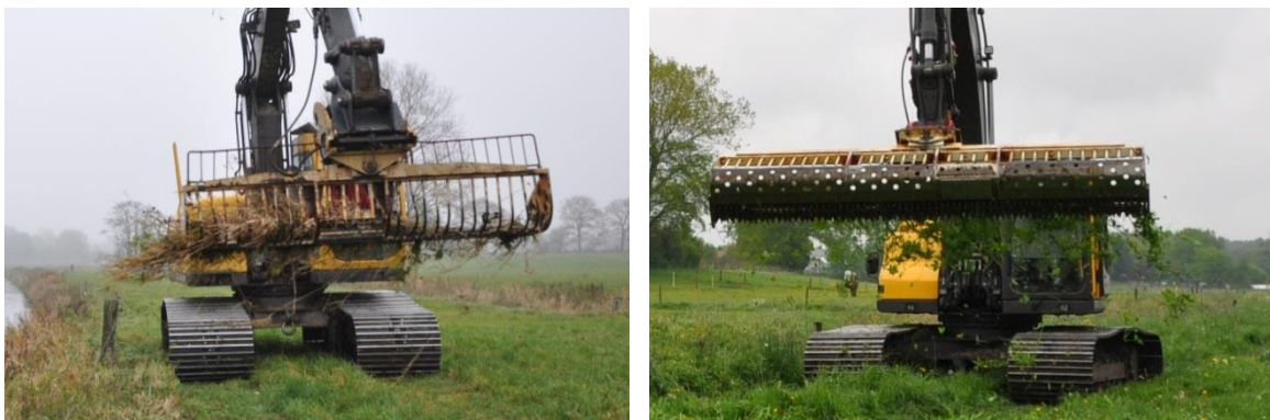
Abb. G3: Vergleich der an der Mühlenbarbeker Au eingesetzten Mähkörbe im Hinblick auf Größe und Ausführung - links: 3 m breiter „offener“ Mähkorb mit Gitterstäben (2010+2011); rechts: 4 m breiter Mähkorb mit schmalen Lochblecheinsatz (2012+2013)
