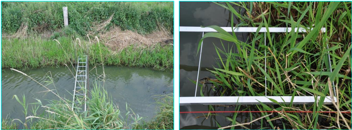
Abb. 6: Transektkartierung: Transekt-Leiter mit Richtschnur über den Gewässerquerschnitt (links) und Detail mit zwei Plots (rechts)
