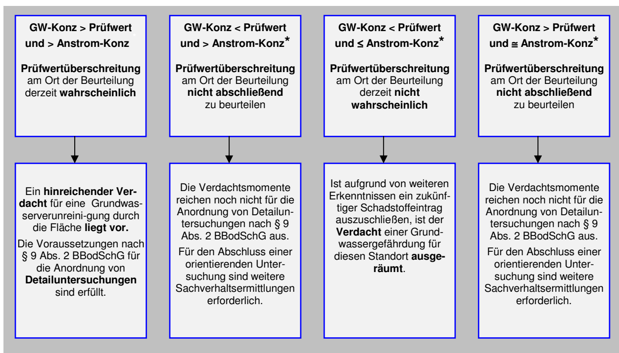
Abbildung 4: Ergebnis der Sickerwasserprognose auf der Basis von Grundwasseruntersuchungen (ALA-Arbeitshilfe)
