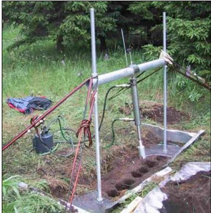
Abbildung 9: Probenahme ungestörter Bodenzylinder auf der WSSA Heede
