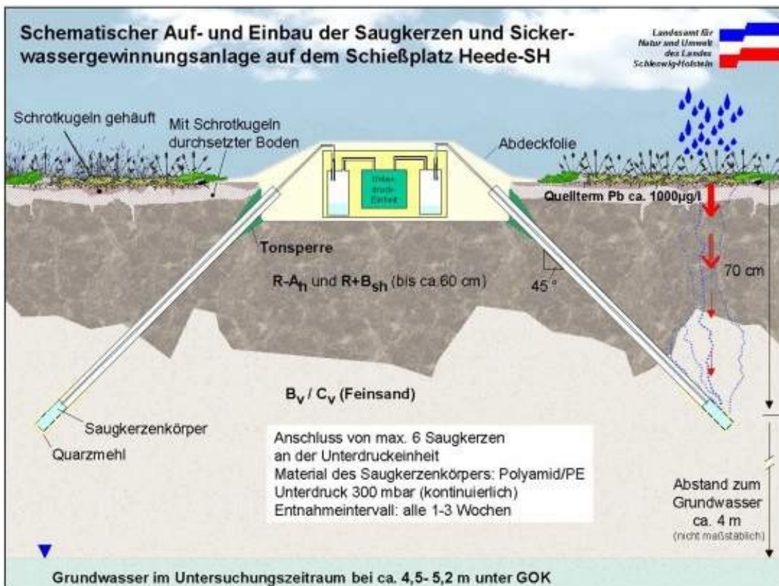
Abbildung 5: Einbau der Saugkerzen auf der WSSA Heede
