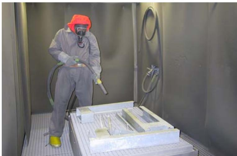
Abbildung 9: Mediumstrahlen von metallischen Komponenten
