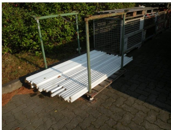
Foto 6: keine korrekte Lagerung von Lampen mit Überlänge
