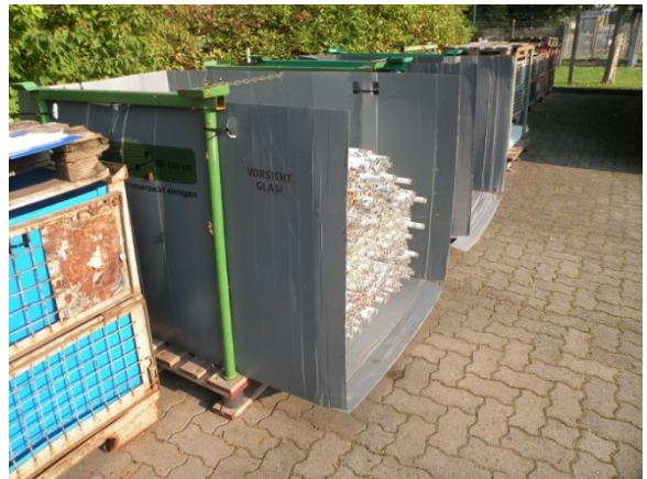
Foto 8: kein Witterungsschutz vorhanden
