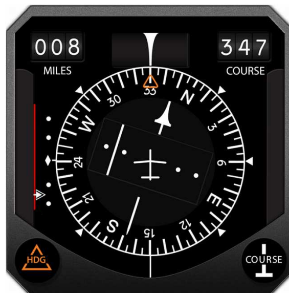
Abbildung 3-6: Klassischer Horizontal Situation Indicator (HSI)
