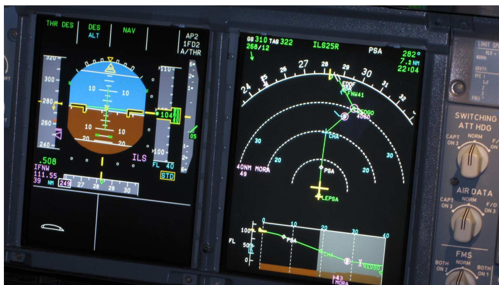
Abbildung 3-7: Primary Flight Display (links) und Navigation Display (rechts) eines Airbus A380 [eigenes Foto]
