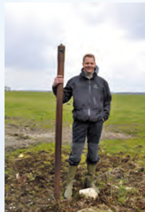
Der freiliegende, etwa 2m lange Teil des Sackungspegels verdeutlicht, wie stark der nicht abgetorfte Moorboden durch Grünlandnutzung während der letzten 200 Jahre ungefähr gesackt ist.
