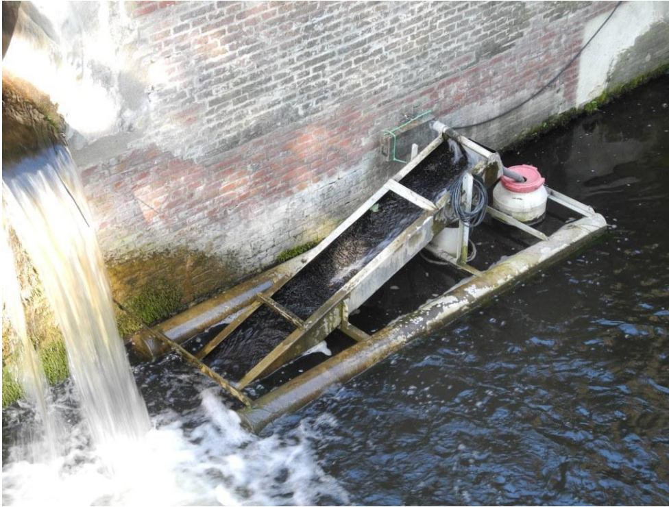
Abbildung 4: Aalfalle der Firma KÖTHKE in der ehemaligen Schleuse Kluvensiek
