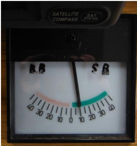
Abbildung 70: Anzeige der Ruderlage auf SD33
