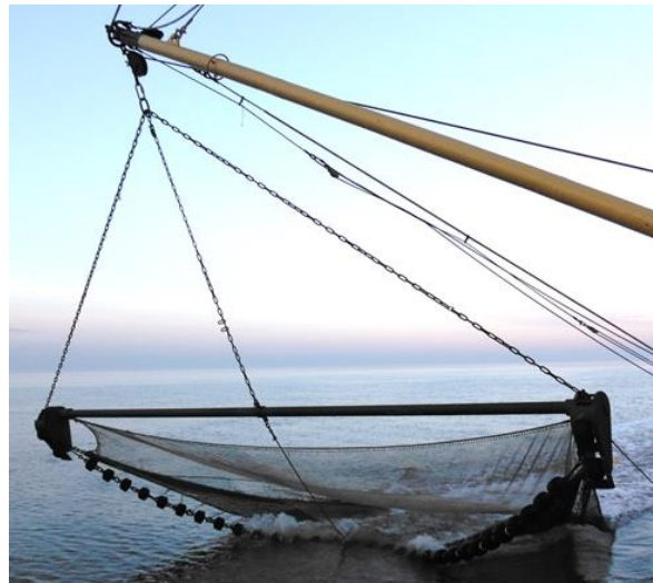
Abbildung 6: Die in den Versuchen auf SD 33 verwendete Standardbaumkurre
