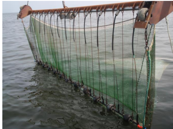
Abbildung 10: In den Versuchen verwendete Rollengeschirre im Vergleich. (A) traditionelles, U-förmiges Rollengeschirr auf der Backbordseite (Baum bereits für Elektroden vorbereitet) (B) Pulsbaumkurre mit geradem Rollengeschirr auf der Steuerbordseite
