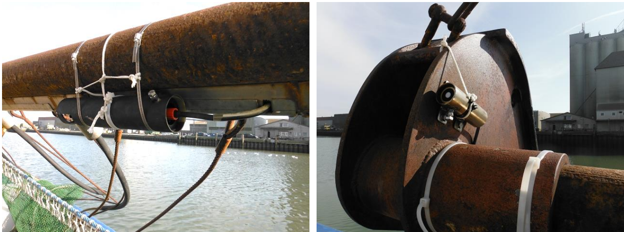
Abbildung 17: Am Baum angebrachter Datenlogger im eigens angefertigten Schutzgehäuse (links) und an der Kufe angebrachter Lichtsensor im eigens angefertigten Schutzgehäuse (rechts)
