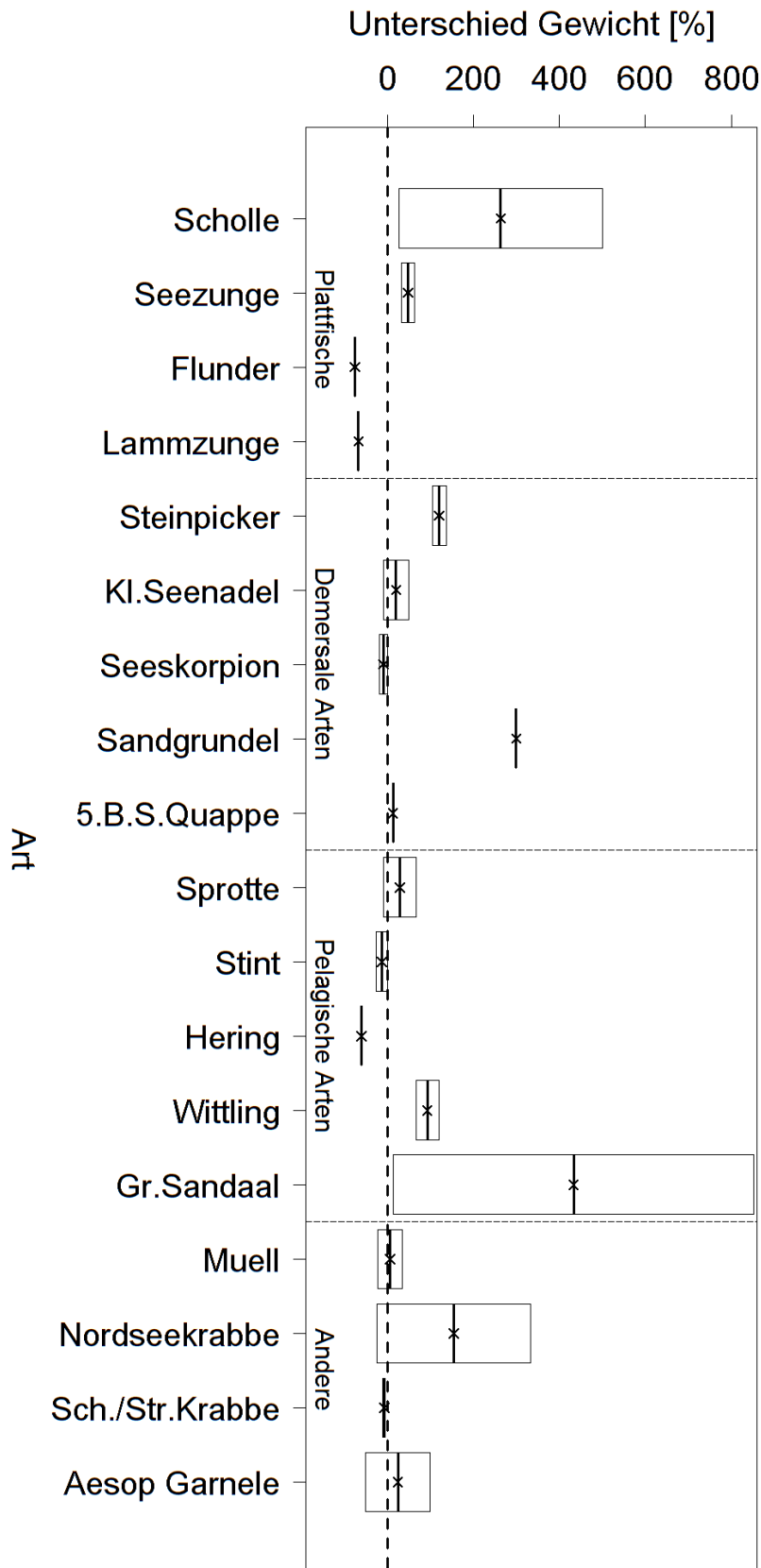
Abbildung 44: Unterschied im Gewicht der im Beifang enthaltenen Arten zweier baugleicher Pulsbaumkurren mit elf 220 mm Rollen und geradem Stahlseilgrundtau. Verglichen wird eine neu installierte Pulsbaumkurre (Backbord) zu der in vorangegangenen Versuchen genutzten Pulsbaumkurre (Steuerbord)
