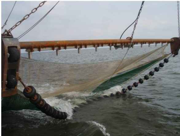
Abbildung 10: In den Versuchen verwendete Rollengeschirre im Vergleich. (A) traditionelles, U-förmiges Rollengeschirr auf der Backbordseite (Baum bereits für Elektroden vorbereitet) (B) Pulsbaumkurre mit geradem Rollengeschirr auf der Steuerbordseite
