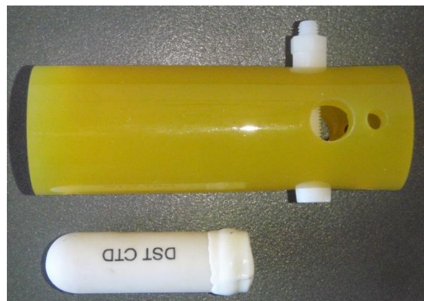
Abbildung 16: Star Oddi CTD Sonde (unten). Die Sonde wurde durch ein Plastikgehäuse (oben) geschützt und am Baum befestigt
