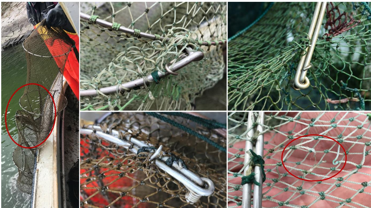
Abbildung 12: Ausstiegsvariante Bügel, das Netz der Reuse hat sich oft an der Feder verheddert, teilweise auch Löcher ins Reusennetz gerissen und musste entsprechend manuell gelöst und geflickt werden, was beim Handling der Reusenketten zu (teilweise großen) Beeinträchtigungen führte.
