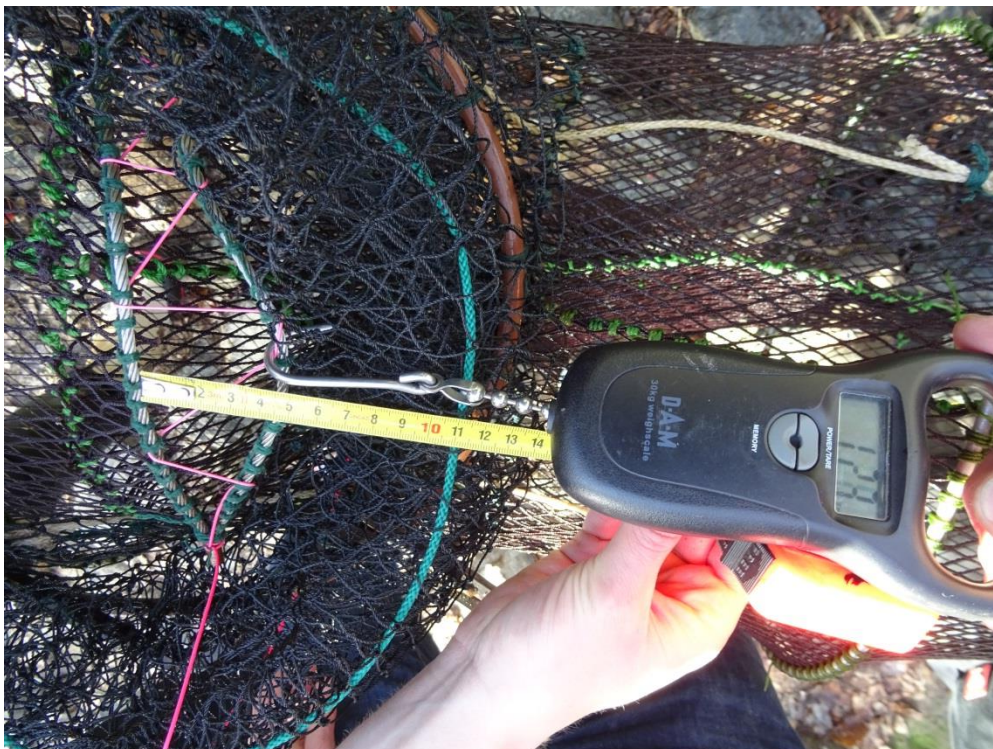
Abbildung 6: Kraftmessung Reusenausstiegstyp I – Reißnaht bei 5cm Öffnung
