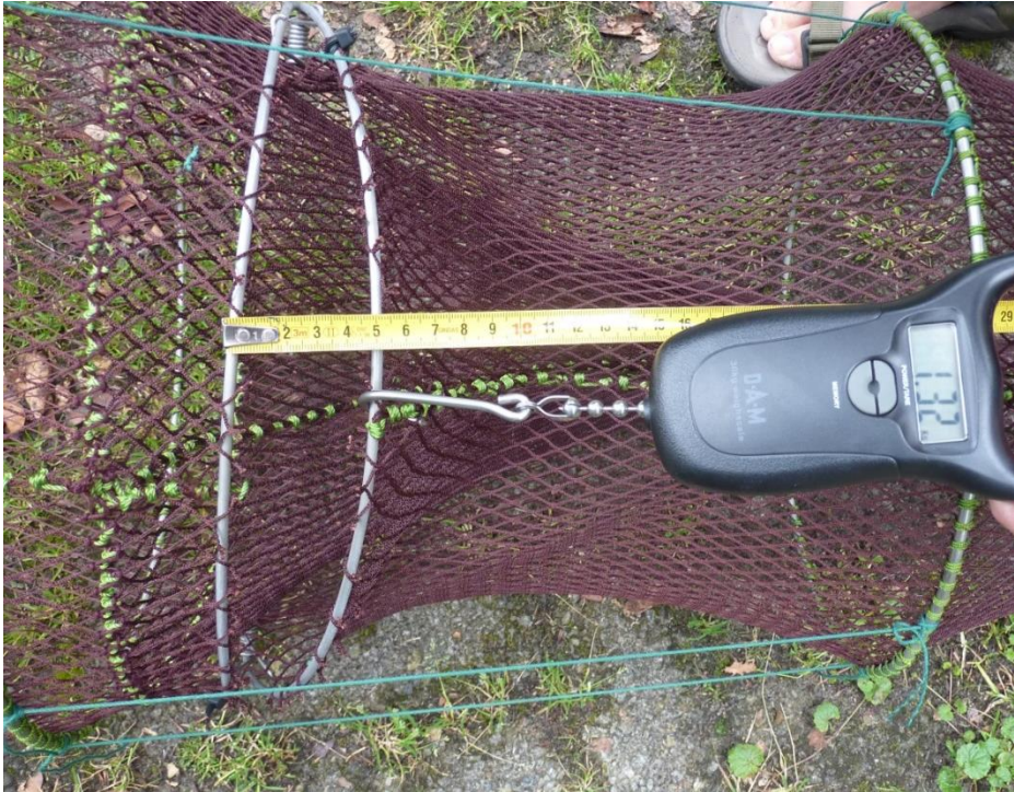
Abbildung 7: Kraftmessung Reusenausstiegstyp II – Metallbügel bei 5cm Öffnung
