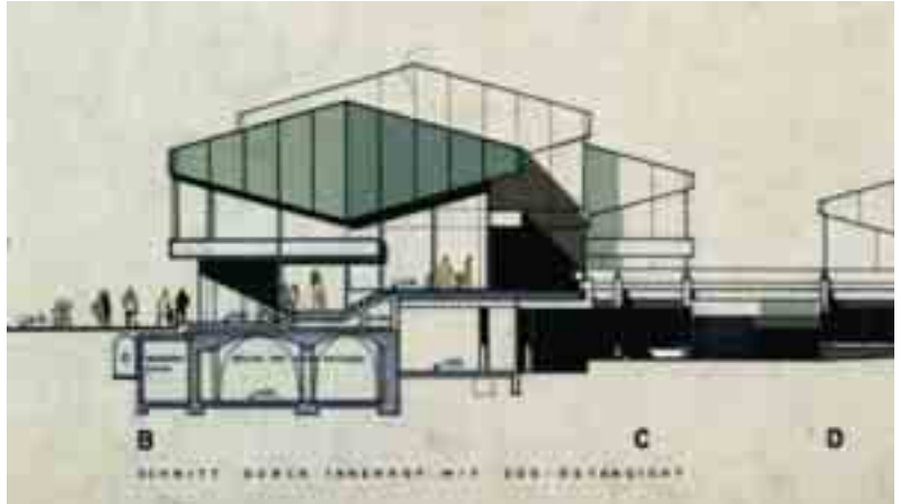
47 Wilhelm Neveling, Ansicht des Hauptpavillons vor der Nikolaikirche, Nordwestseite und Schnitt durch das erhaltene und hier integrierte mittelalterliche Kellergewölbe des Alten Rathauses (Schleswig-Holsteinisches Archiv für Architektur + Ingenieurbaukunst, AAI 871, PL 28, Ausschnitt, dat. 1.8.1970).
